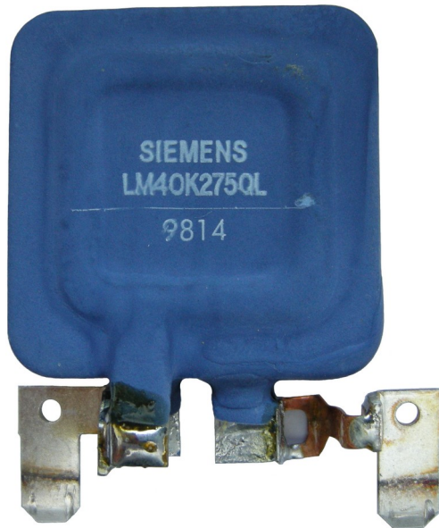
Jeden z trzech bloków warystorowych ogranicznika przepięć typu 3+1 przeznaczonego do sieci o układzie TT (25 kA 8/20 \mu s)
